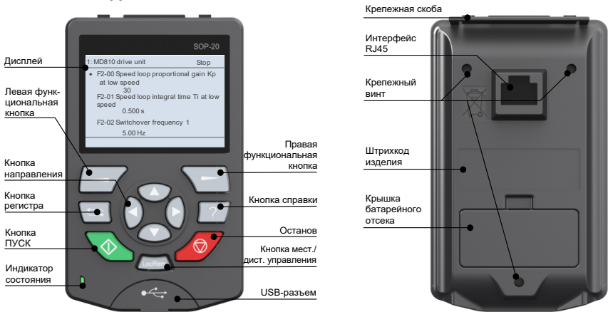
Рис. 4-3 Вид внешней панели управления с ЖК-дисплеем
